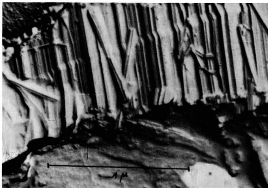
Fig. 10. Druckfläche von unter Druck (5000 atü) bei 236°C schmelzkristallisiertem Polyäthylen (Lindenmeyer, 1964, nach Anderson). Man erkennt wieder die Mosaikblöckchen, die nun entsprechend der sehr grossen Lamellendicke sehr lang gestreckt sind.
